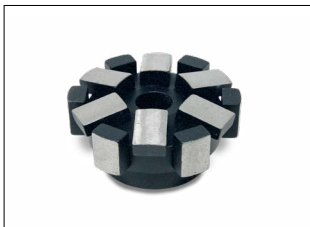
Diamant Einlauffräser Einsatzgebiet: Vorfräsen von Hausanschlüssen, Entfernen von einragenden Stützen und Ablagerungen
